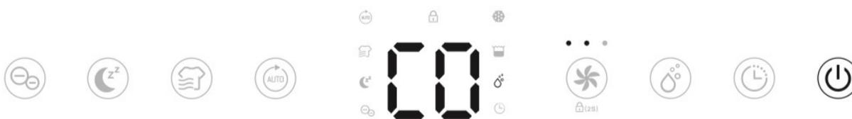
Με ένα πάτημα του πλήκτρου On/Off ενεργοποιείται η συσκευή και λειτουργεί στη χειροκίνητη λειτουργία συνεχούς αφύγρανσης [CO] και στη μεσαία ταχύτητα ανεμιστήρα.
